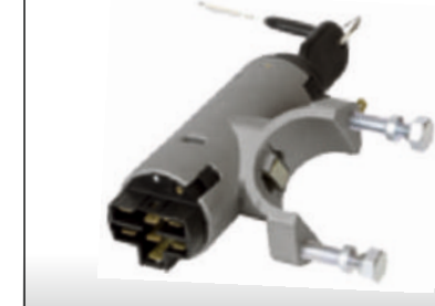
KA 0140 FIAT UNO 50 / 60 / 70 IŞIKLI 1998->2000 KOMPLE KONTAK ANAHTARI OEM NO : 64421445 / Q214AX / A1636
