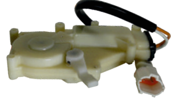
VALOR 1306 : SUZUKI ALTO SAG ARKA KAPI KİLİT MOTORU 2001-> 2 PİN
