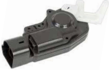
VALOR 0715 : TOYOTA COROLLA SAĞ ARKA MERKEZİ KİLİT MOTORU 1997-> OEM NO : 6914012080
